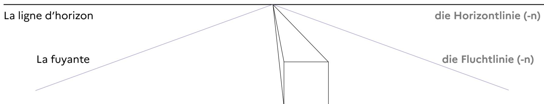
Le point vers lequel convergent les lignes ou arêtes parallèles s'appelle le point de fuite. Celui-ci se trouve sur la ligne d'horizon. La ligne d'horizon correspond à la hauteur des yeux.
